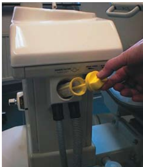
Fasta partiklar som fastnar i sug silen ska hanteras som kvicksilverhaltigt farligt avfall. Sug silen får endast rengöras vid avlopp anslutet till godkänd amalgamavskiljare. Ett alternativ till sug sil kan vara en partikelfälla av engångstyp som lämnas som farligt avfall.
